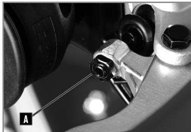
Le frein avant est à disque à commande hydraulique.
