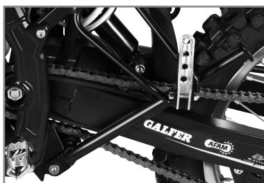
Descendre la béquille (côté gauche) jusqu'en butée puis incliner la moto sur la gauche jusqu'à ce que la béquille soit au contact du sol Contrôler que le sol soit solide et la position stable.
