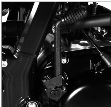
Das Kickstarterpedal ist an der rechten Seite des Motors montiert. Der obere Teil ist drehbar. Zum Starten des Motors den Hebel nach außen drehen und das Pedal kräftig nach unten treten. Das Kickstarterpedal kehrt automatisch nach oben zurück. Nach dem Anlassen das Pedal von Hand wieder in seine Ruheposition zurückklappen.
