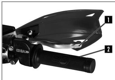
Der Vorderradbremsshebel **1** und der Gashebel **2** sind an der rechten Seite des Lenkers montiert.
