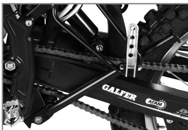
Den Ständer (linke Seite) bis zum Anschlag nach unten klappen und dann das Motorrad nach links neigen, bis der Ständer Bodenkontakt hat. Prüfen, ob der Boden fest und die Position des Fahrzeugs stabil ist.
