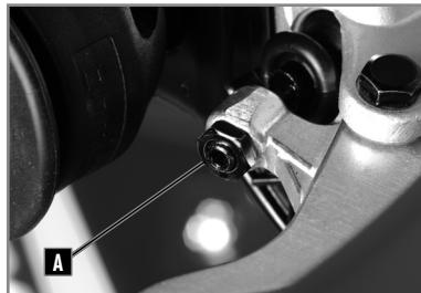
Bei der Vorderradbremse handelt es sich um eine hydraulisch betätigtes Scheibenbremse.
