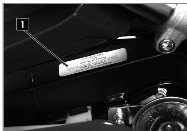
1 Le numéro du châssis est gravée sur la colonne de direction, côté droit.
