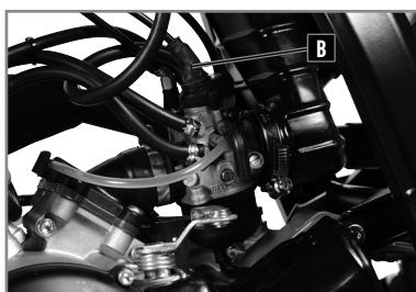
Falls der Gasgriff, an der Griffkante gemessen, um mehr als 3 mm leer läuft, muss dieser am Vergaserregler **B** eingestellt werden.
