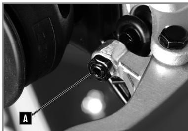
El freno delantero es un disco con control hidráulico. Se puede variar la posición de la palanca pasando a **A**.
