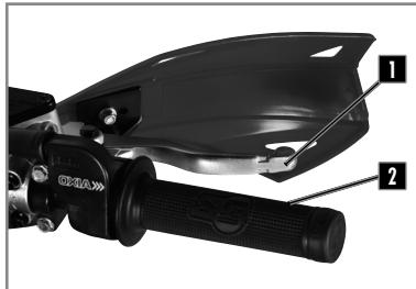
Le levier de frein avant **1** et la manette des gaz **2** sont montés sur le côté droit du guidon.
